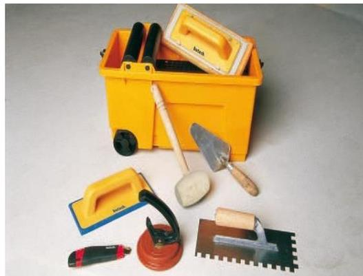
Resulta de gran importancia, en la colocación, la elección de las herramientas útiles adecuadas tanto la llana dentada, como el mazo de goma, (siempre de goma blanca), ventosas y crucetas para la colocación y el mazo de goma o de silicona para el emboquillado.
