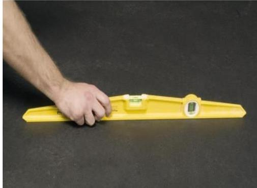
El Soporte (pared – suelo) que se va a revestir debe estar perfectamente nivelado, no presentando defectos de planalidad o diferencia de niveles entre cada losa. Recomendamos la impermeabilización previa de los ambientes El soporte pared o suelo que se va a revestir deben estar húmedos. Una diferencia en el grosor de la capa de adhesivo origina diversas tensiones con la superficie cerámica que terminan provocando desniveles
